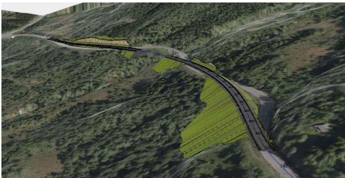
Figur 9. Figur som viser 3D modell av alternativ B med fyllinger og skjæringer. Kilde: Møre og Romsdal fylkeskommune.
