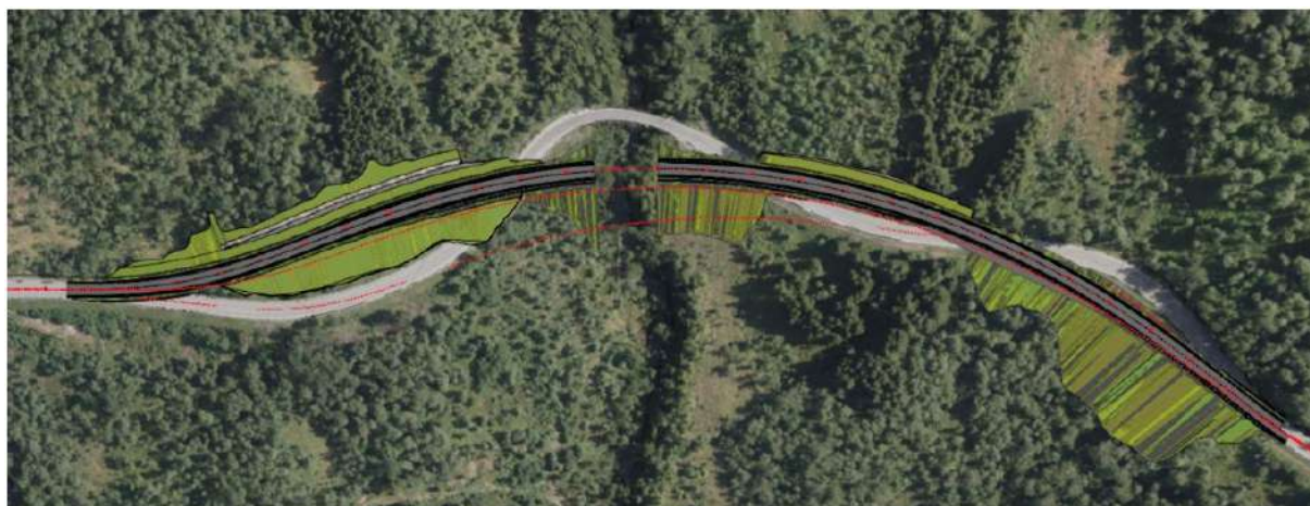
Figur 2 Utdrag fra modell som viser linjeføring av alternativ A. De røde linjene viser referanselinjene mellom de ulike alternativene A, B og C. Kilde: Notat Konseptvalg, Møre og Romsdal fylkeskommune 2024.
