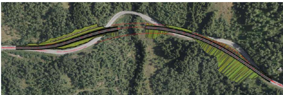
Figur 3 Utdrag fra modell som viser linjeføring av alternativ B. De røde linjene viser referanselinjene mellom de ulike alternativene A, B og C. Kilde: Notat Konseptvalg, Møre og Romsdal fylkeskommune 2024.
