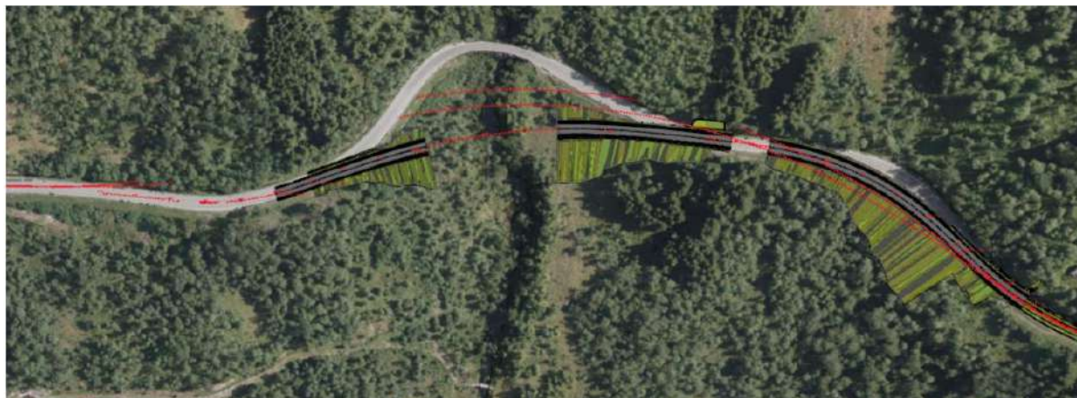
Figur 4 Utdrag fra modell som viser linjeføring av alternativ C. De røde linjene viser referanselinjene mellom de ulike alternativene A, B og C. Kilde: Notat Konseptvalg, Møre og Romsdal fylkeskommune 2024.
