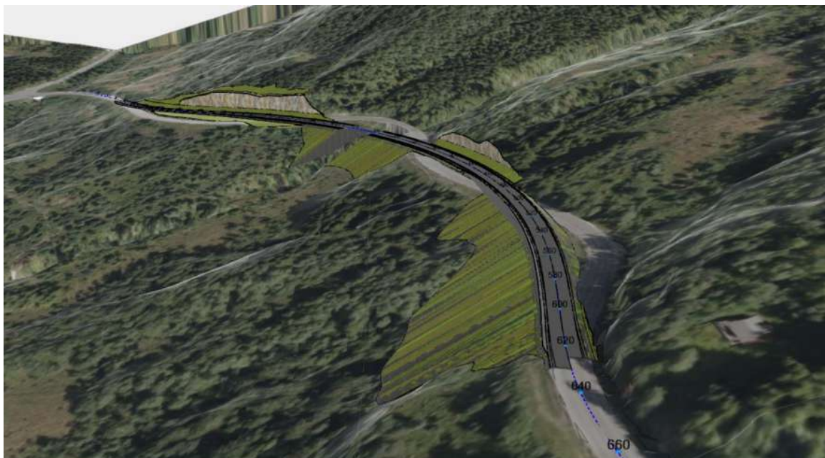
Figur 7. Figur som viser 3D modell av alternativ A med fyllinger og skjæringer. Kilde: Møre og Romsdal fylkeskommune.
