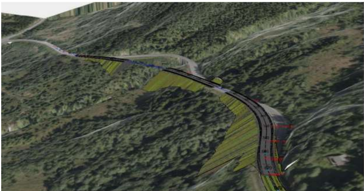
Figur 11. Figur som viser 3D modell av alternativ C med fyllinger og skjæringer. Kilde: Møre og Romsdal fylkeskommune.
