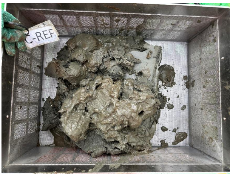
Figur V10.6 Sediment før vask. Lapp indikerer stasjonsnummer.
