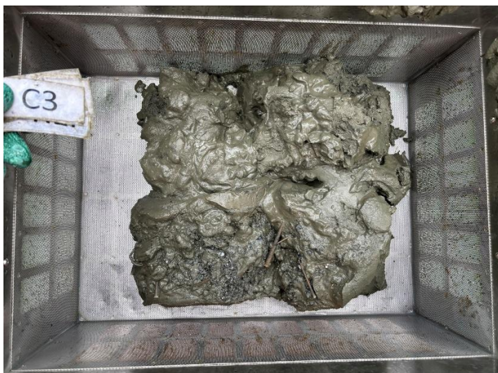
Figur V10.3 Sediment før vask. Lapp indikerer stasjonsnummer.
