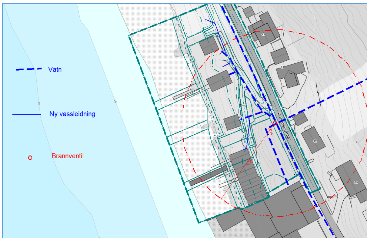
Figur 8 Mogleg plassering av brannventil.
