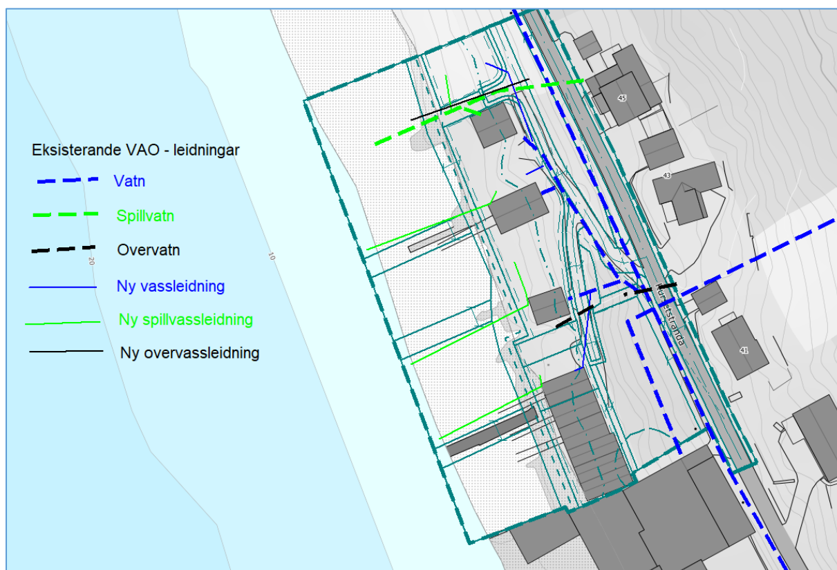
Figur 9 Eksisterande VAO-leidningar og prinsipløysing for nye.
