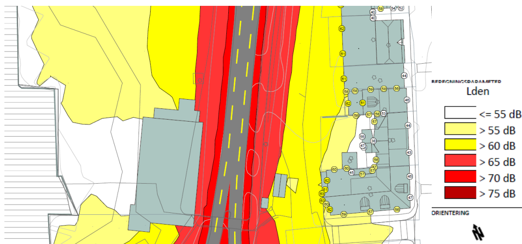
Figur 4: Utsnitt fra tegning X002 - Støynivå L den på fasade og uteareal (1,5 m høyde) etter nytt næringsbygg er på plass.
