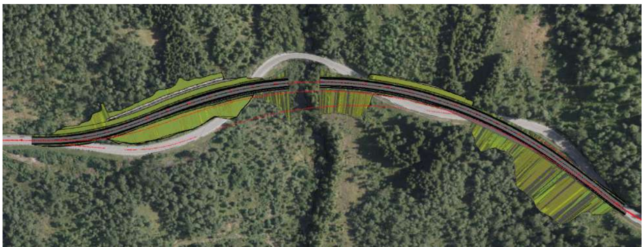
Utklipp 6: Utdraget frå modell viser lineføring til alternativ A. Dei raude linene viser referanselinene mellom dei ulike alternativa A, B og C.
