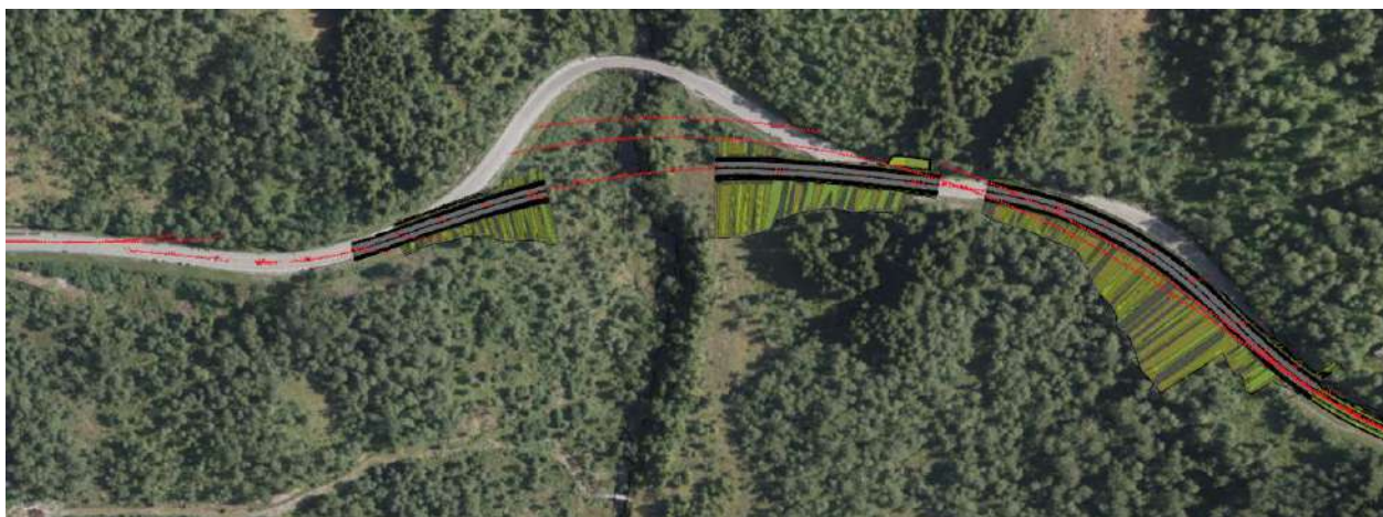
Utklipp 12: Utdraget frå modell viser lineføringa til alternativ C. Die raude linene viser referanselinene mellom dei ulike alternativa A, B og C.
