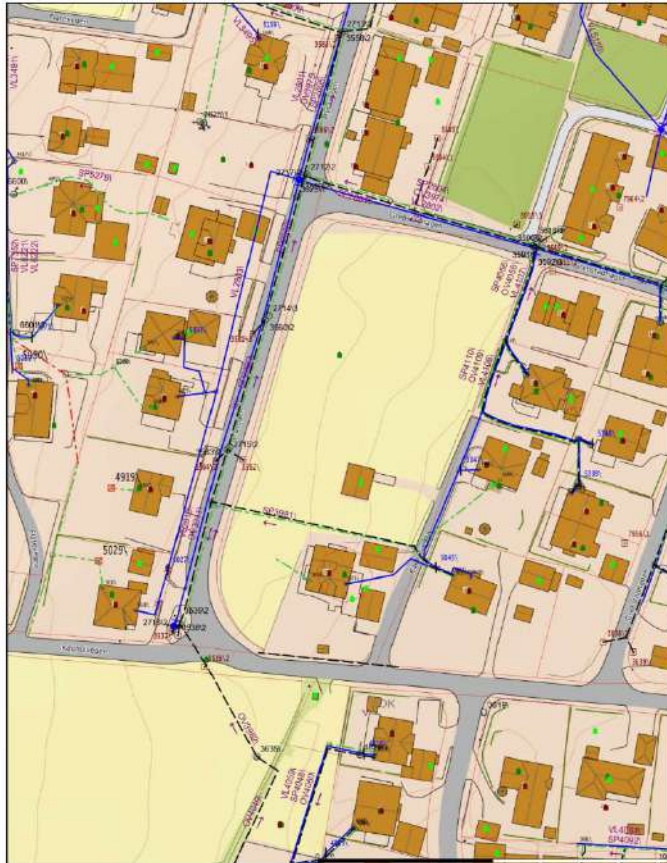
Figur 1 Oversiktstegning av eksisterende VA-ledninger
