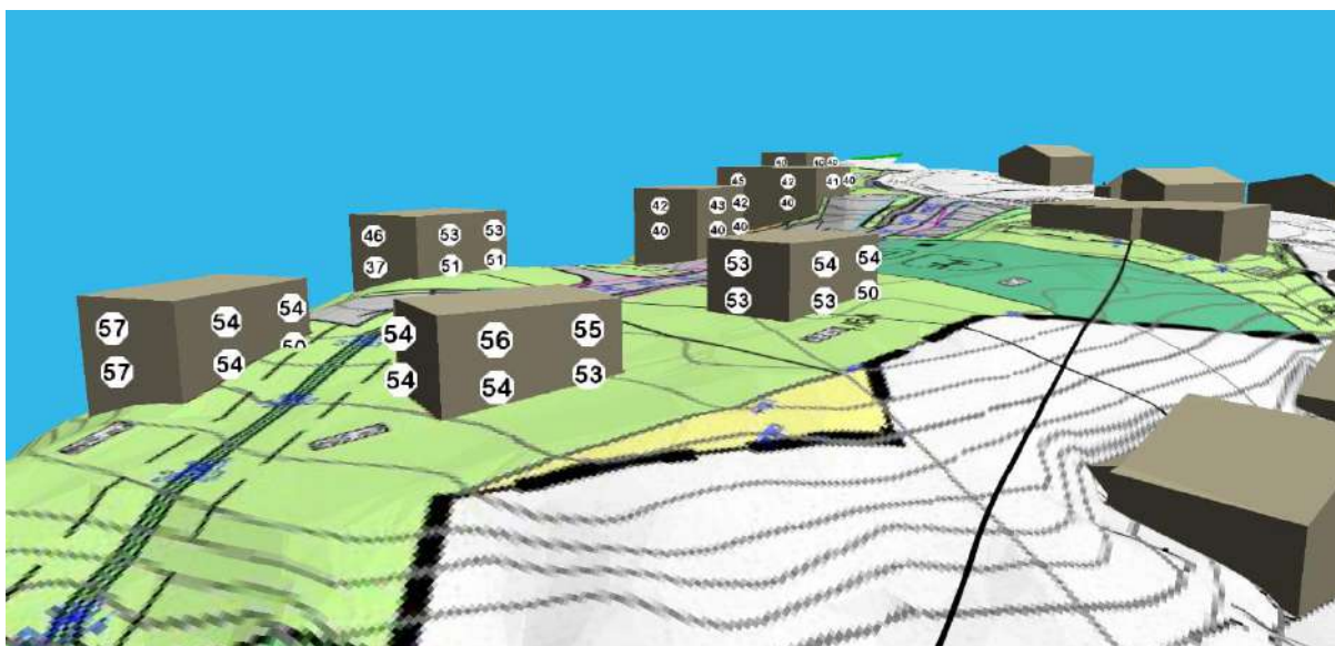
Figur 5-3: Punktberegninger på fasade, L_{AFmax}
