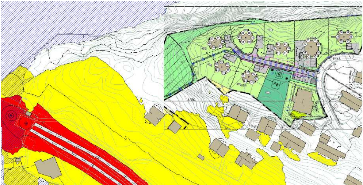
Figur 5-1: Støysonekart i 4 meters høyde, Gul sone L_{den} 55dB- 65 dB, Rød sone L_{den} \geq 65 dB.
