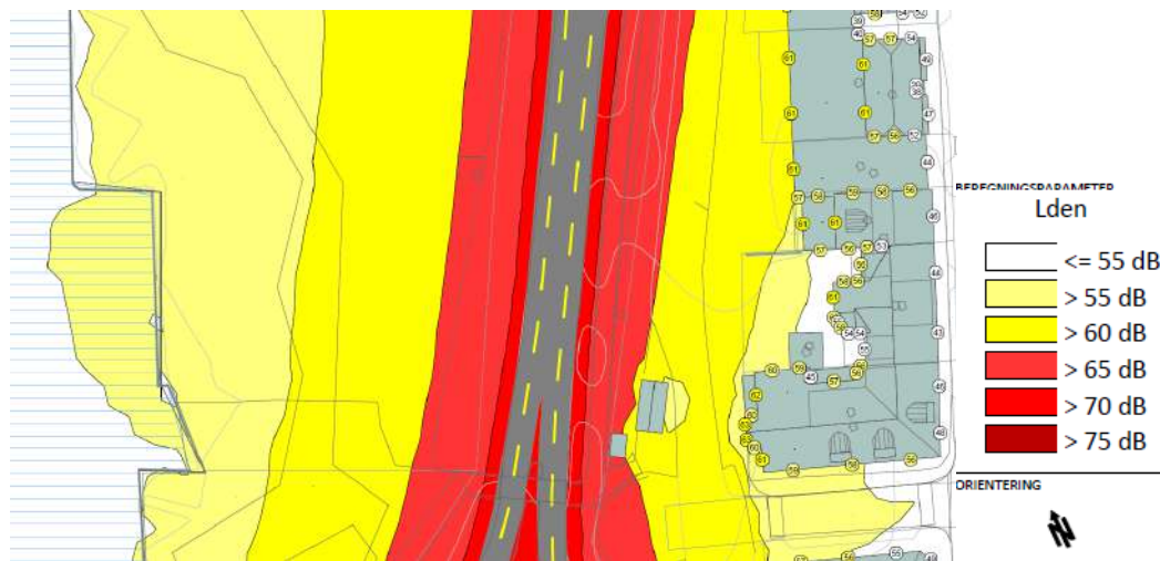
Figur 3: Utsnitt fra tegning X001 - Støynivå L_{den} på fasade og uteareal (1,5 m høyde) før nytt næringsbygg bygges.
