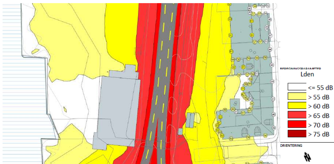
Figur 4: Utsnitt fra tegning X002 - Støynivå L_{den} på fasade og uteareal (1,5 m høyde) etter nytt næringsbygg er på plass.
